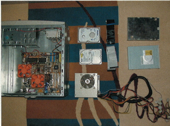
Les différents éléments que nous avons assemblé dans une tour moyenne (3 emplacements 5 pouces 1/4, et 2 3 1/2).
