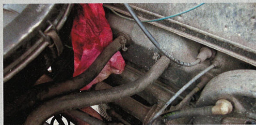
Les arrivées d'eau au radiateur de chauffage : à démonter.
