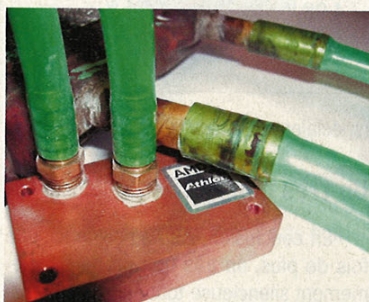
Bien enfoncer les tuyaux sur le radiateur, et sur le waterblock.
