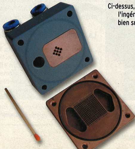
Ci-contre, le CF-1 ouvert. On aperçoit la petite pièce de cuivre chargée de diviser le flux d'eau. Cette technique est connue sous le nom de « spray-cooling ».
